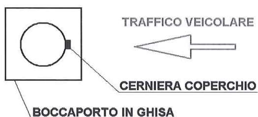
Figura 6: posizionamento ed orientamento del boccaporto nei pozzetti d'ispezione.
